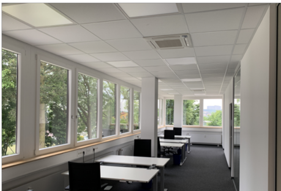
Odenwalddecke mit verbauten Euroastermaßkassetten
