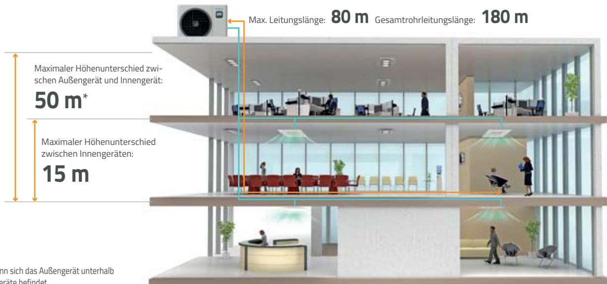
\* 40 m, wenn sich das Außengerät unterhalb der Innengeräte befindet.
