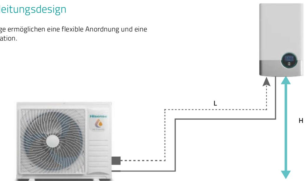
Maximale Rohrleitungslänge L: 45 (50\*) m    Max. Höhenunterschied H: 20/30\*\* m
